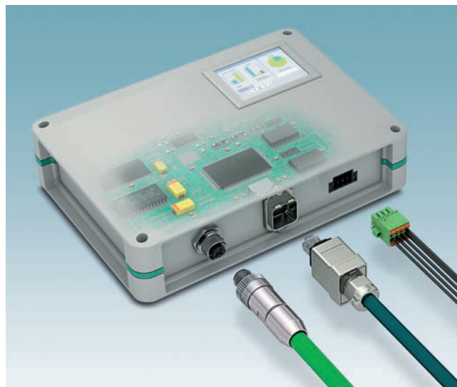
Obr. 3 Pripojenie zariadenia: puzdrá UCS dosahujú vysokú úroveň funkčnosti práve vďaka využitiu všetkých bežných možností pripojenia zariadenia.
